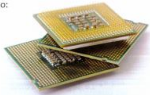
L'oro riveste anche le superfici dei contatti elettrici.
